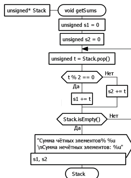
Рис. 1. ДРАКОН-схема для программирования, построенная в среде «Фабула»
