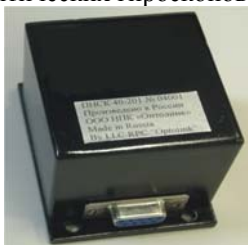
Рис. 21. Фотография модуля с тремя осями чувствительности, изготовленного на основе 3-х ММА, полученных в настоящей работе
