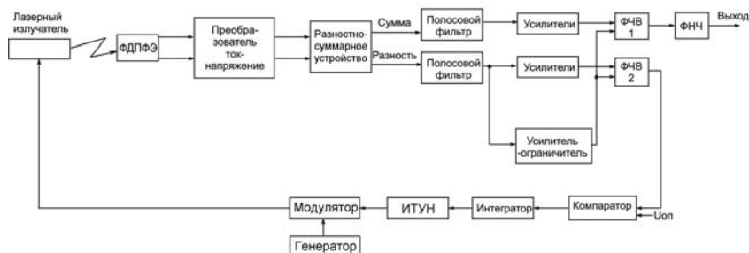
Рис.9. Функциональная схема устройства для снятия АЧХ МЭМС с торсионным подвесом
