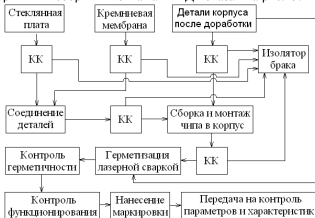
Рис.25. Алгоритм ТП сборки и монтажа ММД
